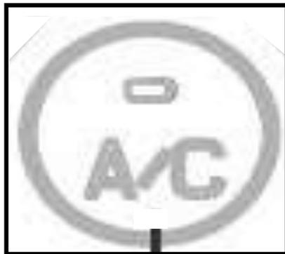
Cuando la luz indicadora está encendida (color amarillo y verde), el compresor se enciende; cuando la luz indicadora se apaga, el compresor se apaga.
