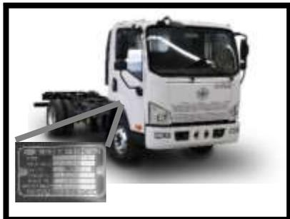
**Posición:** En camión, volquete y vehículo especial, se encuentra en la parte delantera de la viga longitudinal derecha del bastidor.
