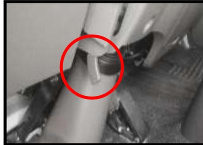
La palanca de posiciones del volante está en el lado izquierdo de la columna de dirección. Suelte la palanca de posiciones para regular la posición del volante. Podrá deslizar hacia arriba, abajo u oscilar hacia adelante, atrás. Después de la regulación, se necesita bloquear la palanca de bloqueo (presione la palanca de bloqueo hacia abajo).
