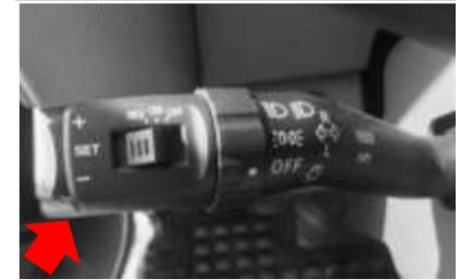
Bajo todas las circunstancias, al elevar la palanca izquierda, se enciende las luces de alta. Para advertir el vehículo delantero o en el lado opuesto a que haga el cambio de luces. Después de soltar la palanca regresará automáticamente y las luces se apagarán.
