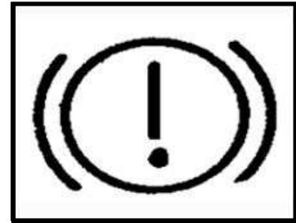
Cuando la presión del cilindro de almacenamiento de aire está por debajo de 0,45MPa, la luz de alarma se enciende.
