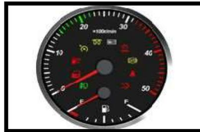
Indica las revoluciones actuales del motor. Si las revoluciones del motor son controladas dentro de la zona de rango óptimo de operación (zona verde), se puede conseguir el óptimo rendimiento del motor; la operación prolongada en la zona de revoluciones excesivas puede causar daño del motor
