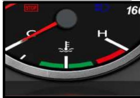
El termómetro indica la temperatura del líquido refrigerante de motor.
