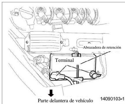
Revise si hay grietas, corrosión, flojedad de conector o abrazadera no fijada.
