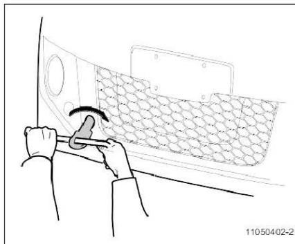
2. Gira el gancho de remolque en la dirección de la flecha para insertarlo. A continuación, apriete el gancho de remolque con la llave de tuercas de rueda.
