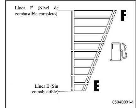
Este indicador de combustible muestra la cantidad aproximada del combustible residual en el tanque de combustible.
