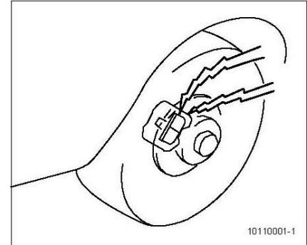
Cuando la pastilla de freno se desgasta, el indicador sobre desgaste de pastilla de freno en el freno delantero de disco sonará un sonido de alarma.
