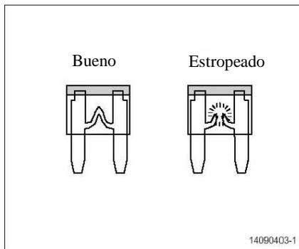
3. Revise el fusible desmontado. Si el fusible se ha estropeado, cámbielo por un fusible de repuesto. Si el fusible no se quema, quizás existen otras causas. Por favor revise el vehículo en un Servicio Oficial.
