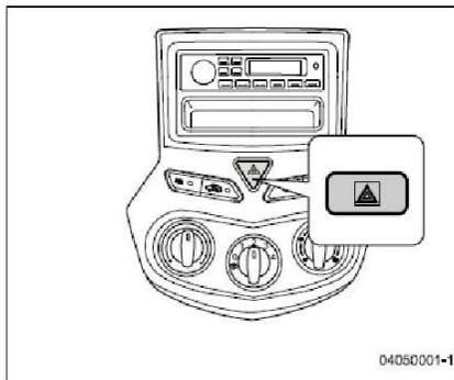
Pulse este interruptor para que todas las luces de señal de giro parpadeen. En este momento, el indicador en el panel de instrumentos comienza a parpadear. Púlselo otra vez para desactivar el interruptor. Con el interruptor de señal de advertencia de peligro activado, el interruptor de
