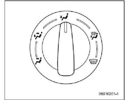
Este panel de control se puede utilizar para cambiar la posición de la salida de aire.
