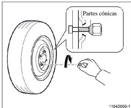
6. Vuelva a instalar todas las tuercas del cubo y las aprieta hasta que las ruedas se sujeten bien.
