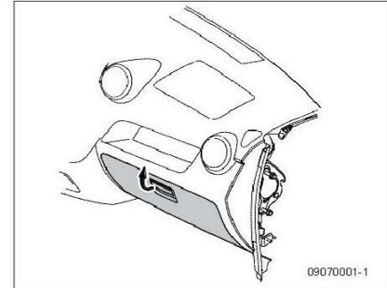
Tire la manija de la guantera, abra la cubierta de la guantera, y empuje la cubierta de la guantera para cerrarla firmemente.
