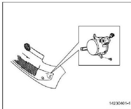
1. Después de desmontar el parachoques delantero, desconecte la abrazadera del conector de cableado para la luz antiniebla, desmonte 3 tornillos, y retire la luz antiniebla delantera.
