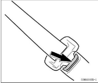
2. Si necesita desmontar el asiento de bebé, deberá presionar el botón de apertura de la hebilla, y hacer que el cinturón de seguridad esté retraído completamente. Esto permite que el cinturón de seguridad sea capaz de expansión y contracción de nuevo
