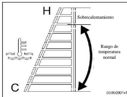
El termómetro de agua indica la temperatura del sistema de enfriamiento del motor después de que el interruptor de encendido sea girado a "ON".
