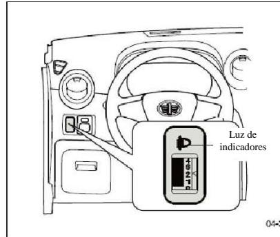
Cuando se requiere la regulación, gire el interruptor de regulador para ajustar la posición vertical de la lámpara de luz de cruce en las luces de combinación delanteras, con el fin de cambiar la altura de irradiación de
