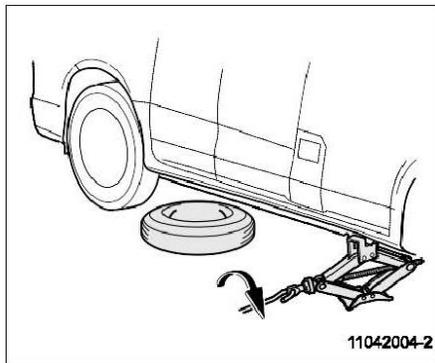
4. Inserta la palanca del gato en el eje sinfin del gato, y eleve el vehículo en dirección igual de las agujas del reloj. Eleve el vehículo lentamente hasta que los neumáticos estén completamente.
