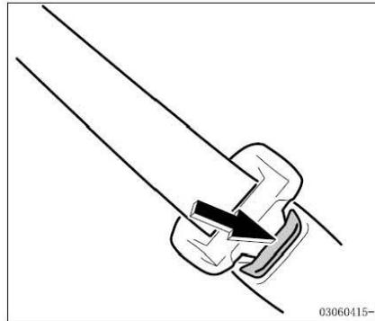
3. Si necesita desmontar el asiento de bebé, deberá presionar el botón de apertura de la hebilla, y hacer que el cinturón de seguridad esté retraído completamente.
