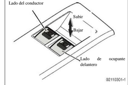
Tire hacia arriba el interruptor para elevar la ventana. Presione hacia abajo el interruptor para bajar la ventana. La ventana se moverá hacia arriba y abajo siguiendo la operación del interruptor.
