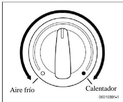
Controle la temperatura del aire a través del panel de control. Cuando no se requiere el calentamiento, gire el panel de control al extremo más izquierdo.
