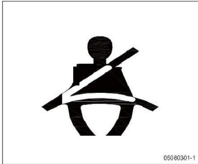
Cuando el conductor no utiliza el cinturón de seguridad, este indicador se enciende.
