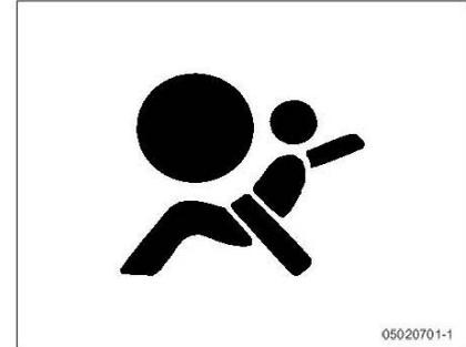
Cuando se detecta una falla, la luz de alarma se encenderá como una advertencia de mal funcionamiento del sistema para el conductor. Después de que el interruptor de encendido sea girado a “ON” cuando el sistema es normal, la luz de advertencia permanecerá encendida durante 6 segundos antes de su apagado.
