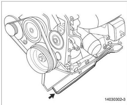
4. Coloca un recipiente debajo del tapón de escape de aceite del motor para vaciar el aceite.
