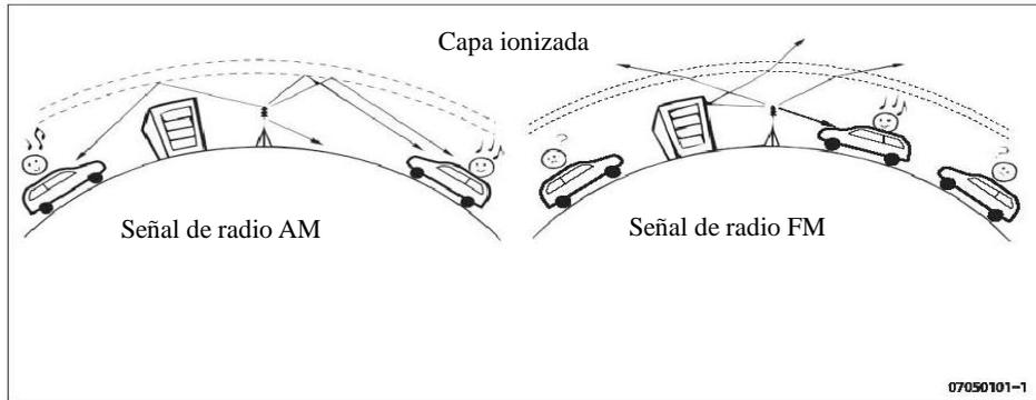
Es que la frecuencia de la señal de radio FM es más alta que la de la señal de radio AM, las características de la señal de radio FM son similares a las de la luz. Por eso, en algunos casos, la señal de radio puede ser bloqueada por los edificios o las montañas, causando la falta de recepción de radiodifusión FM.
