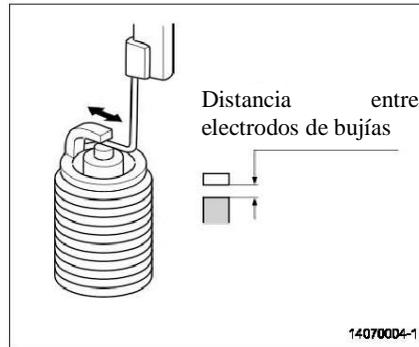
4. Revise la distancia entre electrodos con el calibre de bujía. Doble el electrodo de tierra para ajustar la distancia entre electrodos de la bujía como se especifica si es necesario.
