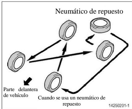
Durante la marcha del vehículo, si los neumáticos están en la misma posición durante un largo tiempo, el desgaste de los neumáticos tendrá su modo uniforme. Por lo tanto, se recomienda intercambiar los neumáticos de forma regular para equilibrar el desgaste.
