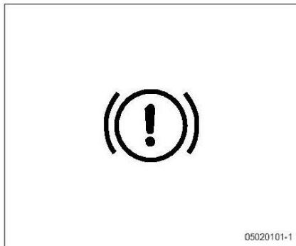
Durante la operación del motor, si el nivel del líquido de freno está tan bajo como la línea “MIN” (mínimo) del depósito de líquido de freno, la luz de advertencia de freno se encenderá.
