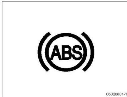
Cuando el sistema está con el interruptor de ignición en la posición “ON”, esta luz de alarma se encenderá por unos segundos y luego se apagará. Los casos siguientes indican que el fallo en el sistema de frenos de antibloqueo (ABS) se puede producir. Deberá verificar el sistema inmediatamente en un
