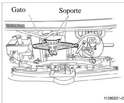
Posición de gato: en el tablero de parachoques de vehículo
