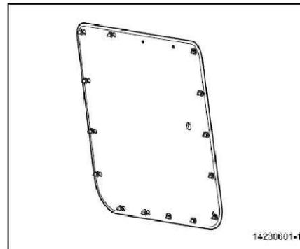
1. Desmonte el panel interior del maletero, y desconecte la abrazadera del conector para cableado de la luz de placa de licencia.
