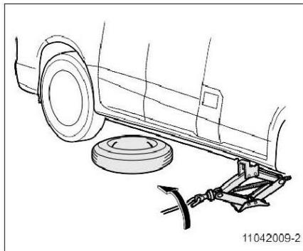
7. Inserte la palanca del gato en el eje sinfín del gato, y baja el vehículo en dirección contraria de las agujas del
