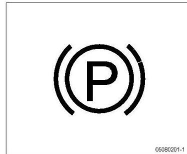
Bajo las circunstancias normales, cuando el interruptor de encendido es girado a “ON” y el mango de freno de estacionamiento es jalado, el indicador de freno de estacionamiento se enciende. Cuando el freno de estacionamiento está liberado después del encendido del motor, la luz de freno de estacionamiento se apaga.
