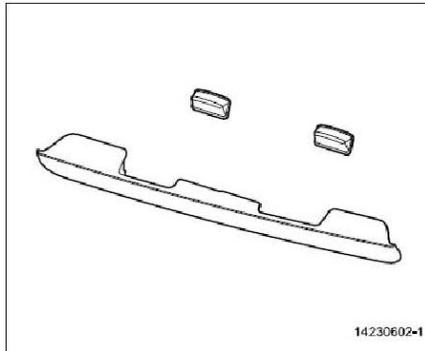
2. Desmonte el panel de luz de placa de licencia, y retire la luz de placa de licencia.
