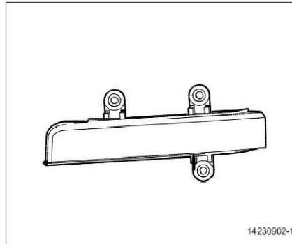
2. Desmonte la tapa de la caja del conjunto de espejo retrovisor exterior, y desmonte el intermitente lateral de señal de giro desde el espejo retrovisor exterior.
