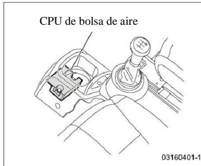
Este dispositivo se utiliza para controlar la bolsa de aire SRS.
