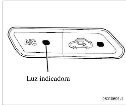
Active el interruptor de acondicionador de aire (A/C) para enfriar o deshumidificar el aire interno. Si quiere encender el acondicionador de aire, pulse el interruptor de acondicionador de aire (A/C) mientras que active el interruptor de ventilador. Si quiere
