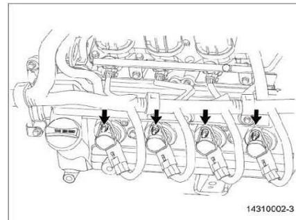
1. Afloje el perno de fijación de la bobina de ignición.
