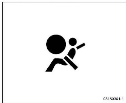
Cuando se detecta una falla, la luz de alarma se encenderá como una advertencia de mal funcionamiento del sistema para el conductor.
