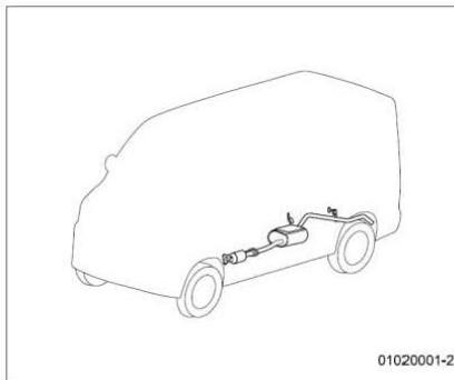
El convertidor catalítico es un dispositivo instalado en el sistema de escape para la reducción de contaminantes de escape.
