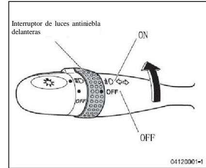
Cuando el interruptor de combinación es girado al 1° o 2° segmento y el interruptor de luces antiniebla delanteras es girado a “ON”, las luces antiniebla delanteras se encienden. Cuando las luces antiniebla delanteras están encendidas, el indicador se enciende.
