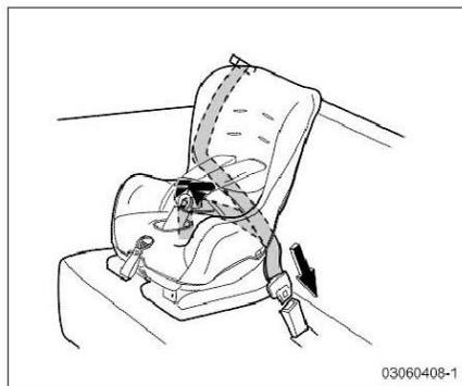
1. Pase las cintas de cintura y hombro a través o alrededor del asiento de niño, a continuación, inserta la lengüeta en la hebilla, y tenga cuidado de no torcer el cinturón de seguridad de acuerdo con las instrucciones proporcionadas por el fabricante. Debe sujetar la cinta de la cintura.
