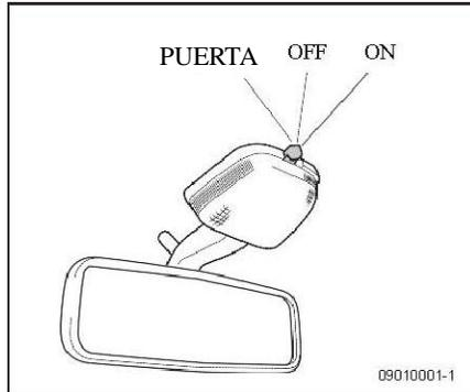
Puede encender la luz de techo con el interruptor de la luz de techo en la posición "ON", y puede apagar la luz de techo con el interruptor de la luz de techo en la posición "OFF". Si cualquier puerta está abierta o no se ha cerrado de forma segura con el interruptor colocado en la posición
