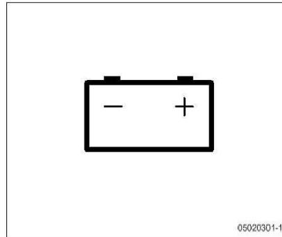
Si se produce un fallo en el sistema de carga durante el funcionamiento del motor, la luz de advertencia se enciende. Apague los accesorios y el motor. Verifique si la correa de accesorios está floja o rota.
