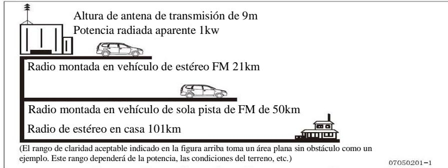
Cuando escucha a la radiodifusión FM con una radio de estéreo en casa, si tira la antena hacia arriba, o utiliza una antena de alta sensibilidad, puede oír la radiodifusión FM clara aunque la señal de radio sea muy débil.
