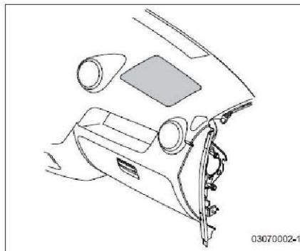
Airbag para el ocupante delantero (si está instalado)
