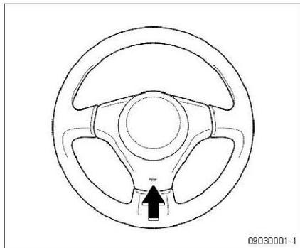
Presiona cualquier parte de la cubierta superior del volante indicada la figura para sonar la bocina.
