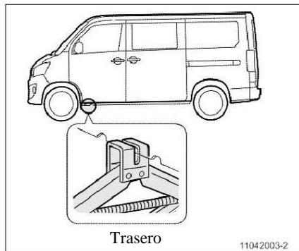
3. Como se muestra en la figura, hay 4 puntos de colocación de gato, 2 por cada lado. Ponga el gato en el punto de soporte más cercano al neumático pinchado.
