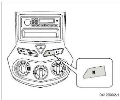
Cuando el interruptor de combinación es girado a 1° o 2° segmento y el interruptor de luces antiniebla traseras está pulsado, las luces antiniebla traseras se encienden. Cuando las luces antiniebla traseras están encendidas, este indicador se enciende.
