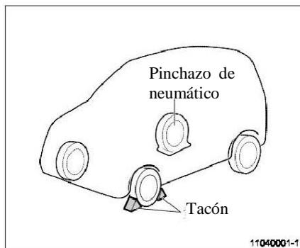
Retenga el neumático del otro extremo diagonal de la rueda pinchada con un tacón.
