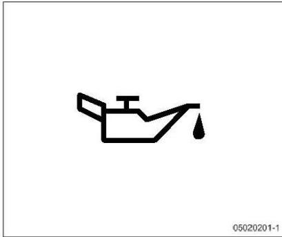
Si se produce un fallo en el sistema de lubricación durante el funcionamiento del motor, la luz de advertencia se enciende.
