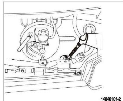
Durante la refrigeración del motor, revise el nivel de refrigerante en el depósito de líquido.
