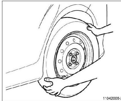
5. Desmunte las tuercas del cubo, y reemplace el neumático pinchado por el neumático de repuesto.
