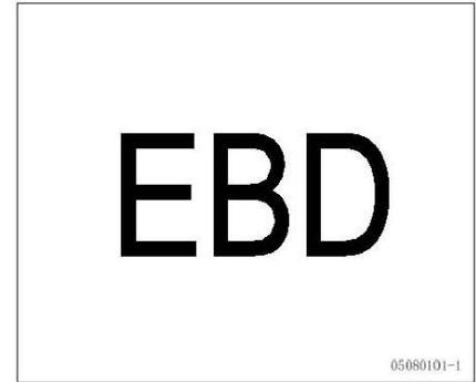
Cuando el sistema es normal con el interruptor de ignición en la posición “ON”, esta luz de alarma se encenderá por unos segundos y luego se apagará. Los casos siguientes indican que se puede producir un fallo en EBD, deberá verificar el sistema inmediatamente en un Servicio Oficial.
