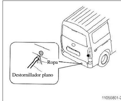
El gancho de remolque trasero para remolcar otros vehículos se encuentra en el lado derecho de la carrocería.
