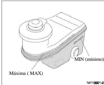
Mire si el nivel de líquido en el depósito de freno está entre líneas de nivel “MAX” (máximo) y “MIN” (mínimo). Si el nivel de líquido de freno es demasiado bajo, añada lentamente líquido de freno hasta la línea “MAX” (máximo).
