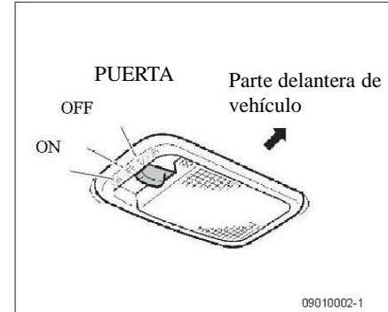
Puede encender la luz indicadora de puertas con el interruptor de la luz indicadora de puertas en posición "ON", y puede apagarlo con el interruptor de la luz indicadora de puertas en la posición "OFF".
