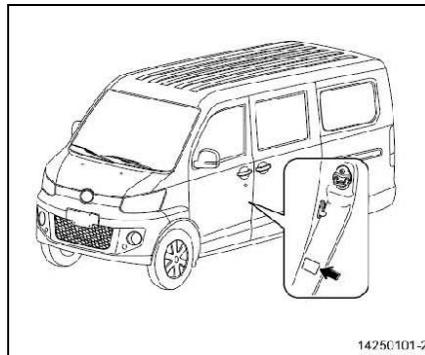
Revise la presión de los neumáticos en frío con el manómetro. Sobre la presión de los neumáticos, por favor consulta a Sección 15 o la etiqueta de neumático en la posición indicada de la figura.
