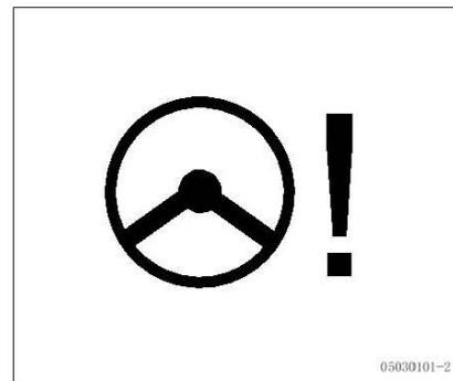
Cuando el sistema es normal con el interruptor de ignición en la posición “ON”, esta luz de alarma se encenderá por unos segundos y luego
