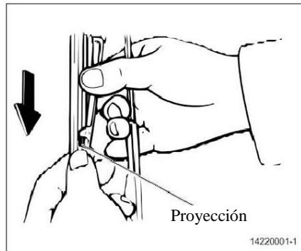
1. Saque la cuchilla de limpiaparabrisas mientras presiona la cuchilla de limpiaparabrisas y la mantiene.
