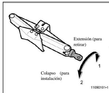
Gire el eje sinfín para instalar/desmontar el gato, como se muestra en la figura anterior.
