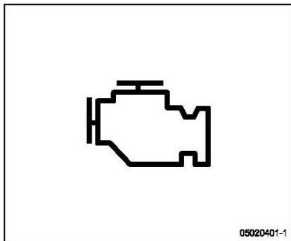
Si se produce un fallo en el sistema de control electrónico del motor durante el funcionamiento, MIL se enciende.
