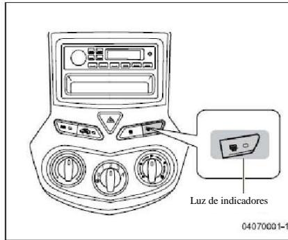
Cuando el interruptor de encendido es girado a “ON”, puede operar el desempañador de la ventana trasera. Pulse el interruptor de desempañador para desempañar la ventana trasera. Con el desempañador encendido, el indicador se enciende. El desempañador no se utiliza para el
