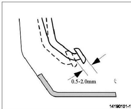
Apague el motor y pise el pedal de freno 5 veces o más, para liberar el vacío en el aumentador de presión.
