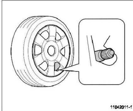
9. Para la instalación de la cubierta de la llanta, debe golpear la cubierta central o la tapa de la rueda, y alinear la ranura con válvula.
