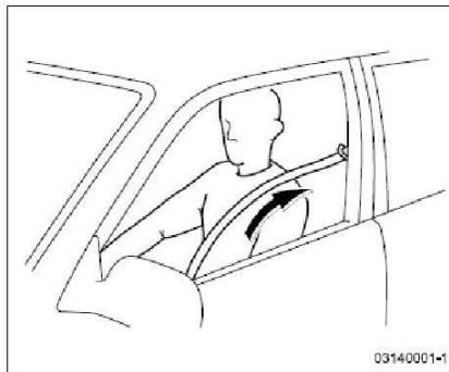
Cuando se somete a un impacto intenso desde el frente, el mecanismo pretensor estará activo. El pretensor retraerá el cinturón de seguridad de inmediato y fija firmemente la parte superior del cuerpo del ocupante, y mejora la función del cinturón de seguridad y el airbag SRS.
