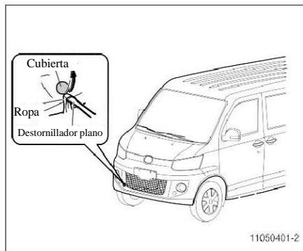
1. Enrolle el destornillador plano con un paño o similar, e inserta el destornillador en una ranura en la cubierta. A continuación, retira la tapa.
