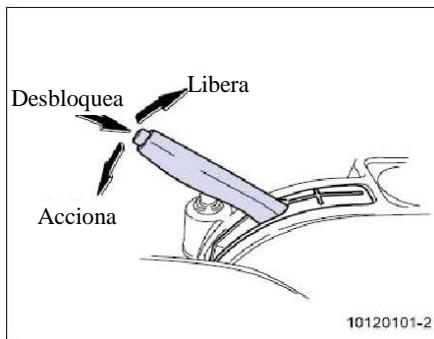
Eleva la palanca de freno de estacionamiento para accionar el freno de estacionamiento.
