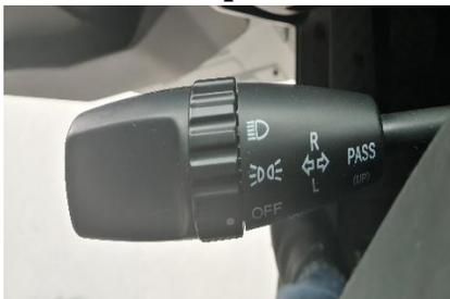
Palancas multifunciones abarca: Interruptor de luces, interruptor de cambio de luces, interruptor de luces intermitentes; interruptor de limpiaparabrisas, interruptor de líquido limpiaparabrisas.
