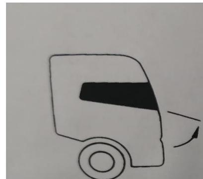
2. abrir la placa posterior del camión para que este no se doble o rompa a la hora de abatir la cabina.
