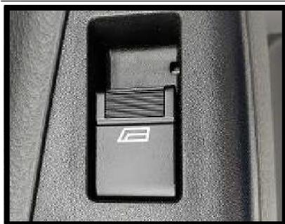
Se puede elevar y descender el vidrio de la puerta presionando el botón del elevador de vidrio. Hay dos botones de operación en el lado del conductor, con los cuales se puede operar la elevación o el descenso del vidrio del lado del conductor y lado copiloto.
