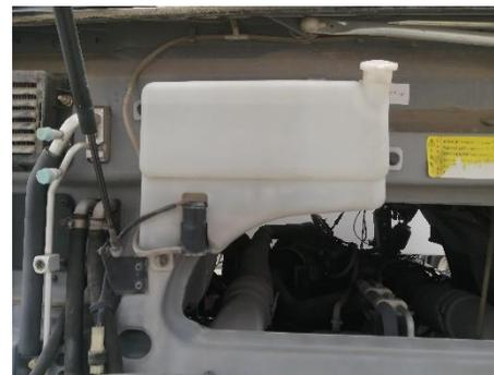
Depósito limpiaparabrisas se ubica en la parte frontal del vehículo, se puede llegar a ella abriendo la placa posterior, aquí encontrará el depósito de agua.
