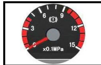
El indicador de presión de aire contiene dos agujas. La aguja superior indica la presión del circuito de frenado delantero y la inferior indica la presión del circuito de frenado trasero. Si la aguja se ubica en zona roja, significa que la presión está alta o baja.
