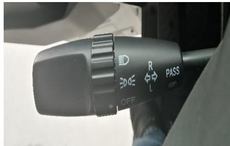
Bajo todas las circunstancias, al elevar la palanca izquierda, se enciende las luces de alta. Para advertir el vehículo delantero o en el lado opuesto a que haga el cambio de luces. Después de soltar la palanca regresará automáticamente y las luces se apagarán.
