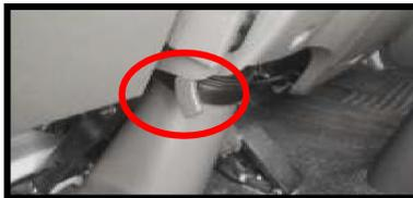
La palanca de posiciones del volante está en el lado izquierdo de la columna de dirección. Suelte la palanca de posiciones para regular la posición del volante. Podrá deslizar hacia arriba, abajo u oscilar hacia adelante, atrás. Después de la regulación, se necesita bloquear la palanca de bloqueo (presione la palanca de bloqueo hacia abajo)
