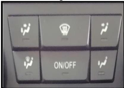
Para seleccionar la posición de la apertura de aire durante la refrigeración y calefacción, se puede seleccionar hacia el área del rostro, aire en la zona de cara y pies, zona de pies, zona de pies y calefacción en zona 1 y 2, y calefacción total.
