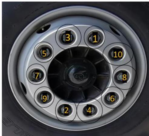
**Paso 6:** Apriétela al torque especificado según la secuencia indicada en la figura.
