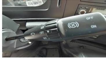
La palanca derecha cuenta con la función de interruptor de limpiaparabrisas, interruptor de líquido limpiaparabrisas, interruptor de freno de escape.
