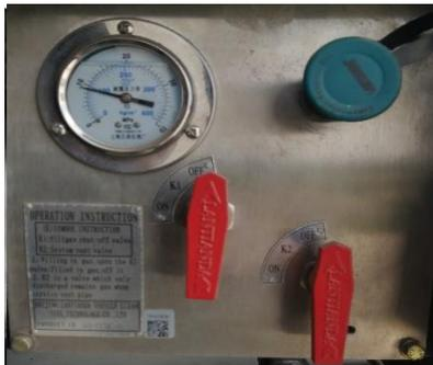
Ubicado en el lado izquierdo en la parte inferior de los cilindros del vehículo, abra la tapa de la caja de control de llenado de gas.
