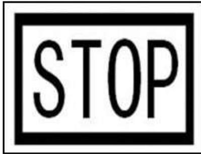
Cuando encienda la luz indicadora es que existe una falla en el sistema de enfriamiento, el sistema de frenos, la presión de aceite. Esta luz indicadora advierte al conductor, para estacionar el vehículo y realizar una inspección según la advertencia o falla.
