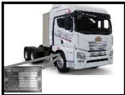
**Posición:** Se encuentra en la parte delantera de la viga longitudinal derecha del chasis.
