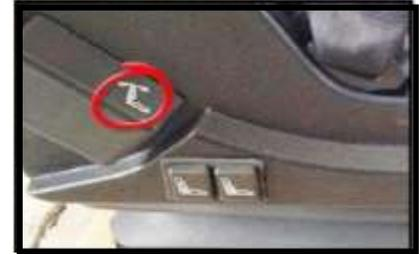
El soporte lumbar neumático se divide en la parte superior y la parte inferior, cada parte es controlada por su botón independiente, presione la parte superior/ inferior del botón para regular el nivel de soporte del soporte lumbar.
