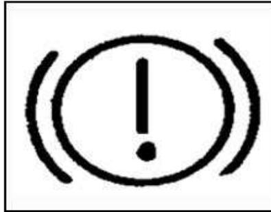
Cuando la presión del cilindro de almacenamiento de aire está por debajo de 0,45MPa, la luz de alarma se enciende.
