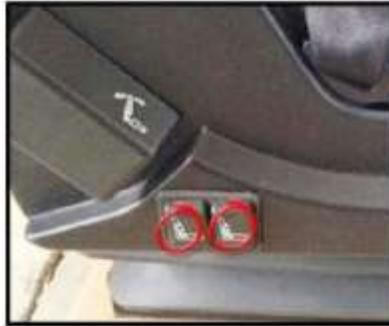
Jale la palanca de regulación de ángulo hacia arriba, utilice la fuerza de la espalda del cuerpo para regular el respaldo del asiento a un ángulo adecuado, luego libere la palanca para bloquear el respaldo.
