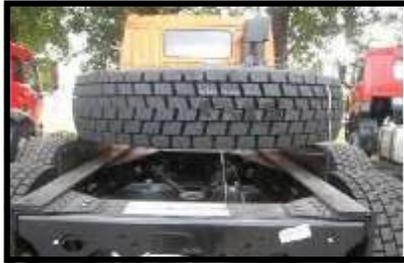
En situaciones de emergencia utilice el neumático refacción este se encuentra situado en la quinta rueda de la unidad. Retire los soportes de fijación y el neumático quedara libre.
